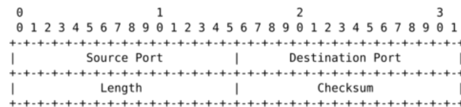
Fig. 19: UDP Header Format
