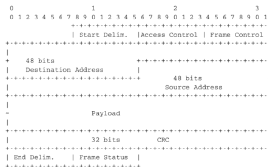
Fig. 76: 802.5 data frame format
